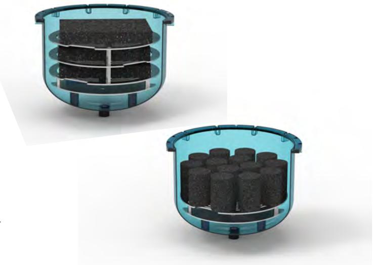
这种高效率的试验能力在实际试验时非常有用，按照AASHTO TP140规范的建议，为了能够更有效的模拟水分对于沥青和集料之间黏附力的破坏，要求浸水高温养生的时间应达到20个小时（早期研究表明最初的ASTM D7870没有这种养生时间的要求，因此主要反映沥青内聚力损失导致的破坏）。如果实验室没有其他的高温水浴，直接使用该水热敏感性试验仪来进行试件的养生，则整个试验的时间要在1天左右，也就是测试效率是2-3个试件/天。实在是太慢了！这也是我们为什么要扩大容器尺寸的原因。
