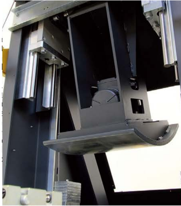
集成了振动功能单元的扇形钢轮细节图
