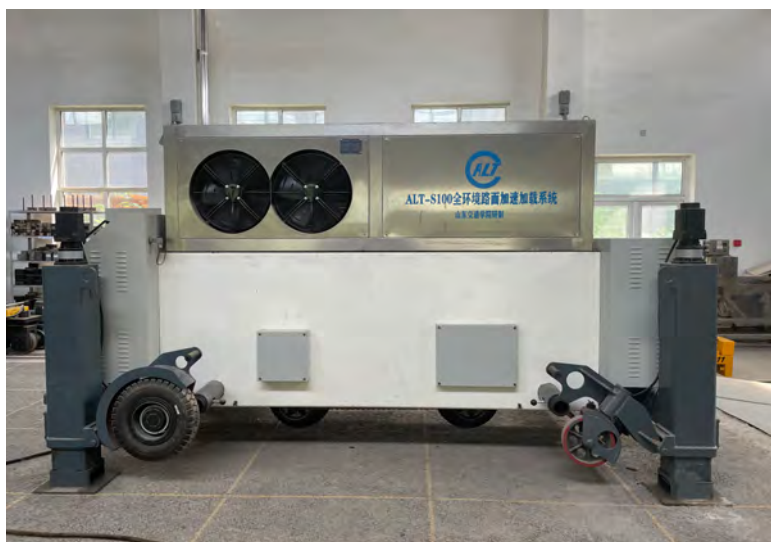
图2：ALT-S100侧面图（支腿、转向轮、测试轮和驱动轮等）
