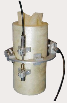
图2 安装于试样上的 LVDT 传感器
