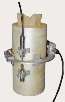
图 2 试样上安装 LVDT 传感器示意图
